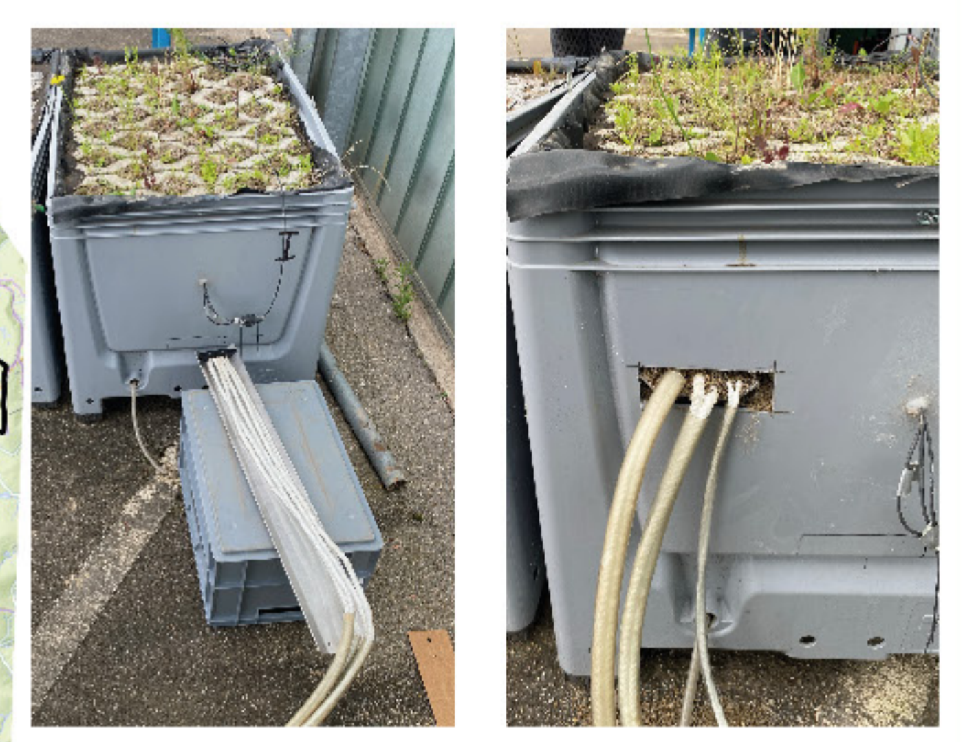
Versuchsaufbau zum Test der Saugleistung verschiedener Docht-Materialien (erster Prototyp) in einen reaktivierten Lysimeteraufbau (ehemaliges BMBF-Forschungsprojekt). Döchte werden in einer Edelstahlchiene befestigt und horizontal in den Boden gepresst.
