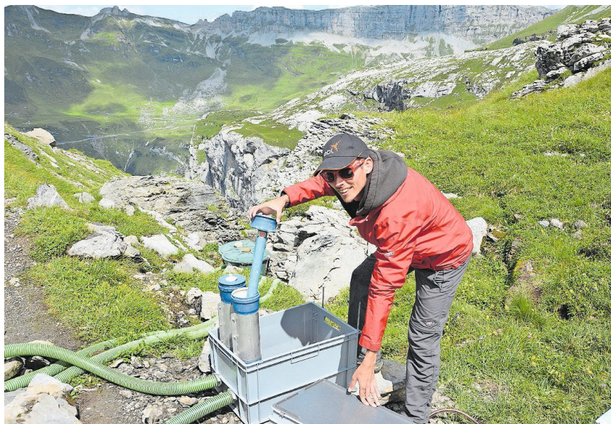
Hydrologie-Assistent Florian Lustenberger kontrolliert die Bernolli-Tubes.
