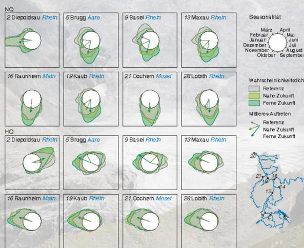
Abbildung 21: Kreisdiagramme ausgewählter Messstationen zeigen das zeitliche Auftreten der jährlichen minimalen (NQ) und maximalen (HQ) Abflüsse als Wahrscheinlichkeitsdichteverteilung um den Referenzzeitraum.
